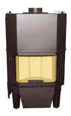
Каминная топка PRISMA K - это топка средних размеров с призматическим стеклом и большим обзором огня. Она может быть установлена как в угол, так и пристенно. Топочная камера выполнена из шамота, а герметичный корпус из стали. Оснащена регулируемыми ножками, благодаря которым можно корректировать высоту.
